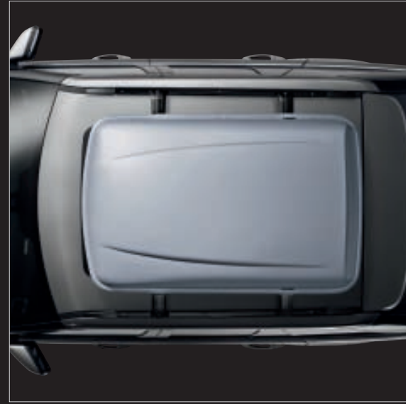
Caja portaequipajes* VPLDR0003 Con cierre de seguridad. Se abre desde los dos lados. Dimensiones exteriores: 1.600 mm de largo, 960 mm de ancho y 410 mm de alto. Volumen: 450 litros. Capacidad de carga: 54,8 kg.
