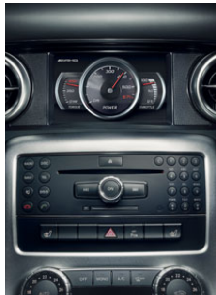
Equipo opcional. AMG Performance Media, visualización del par motor, la potencia y la posición del acelerador.
