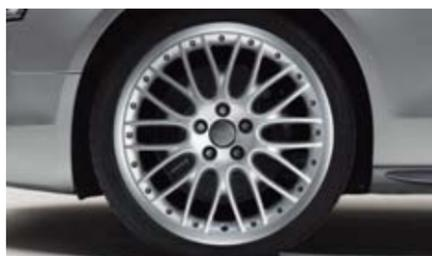
Llantas de aleación de aluminio Audi exclusive con diseño de 20 radios, en dos partes, tamaño 9 J x 19 con neumáticos 255/35 R 19. Una oferta de quattro GmbH
