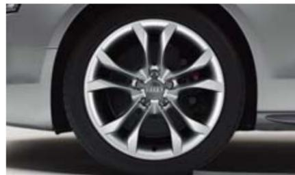
Llantas para invierno de aleación de aluminio con diseño de 5 radios paralelos en estrella, tamaño 8 J x 18 con neumáticos 245/40 R 18, velocidad máxima autorizada 240 km/h, aptas para cadenas (No disponibles en España)
