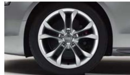
Llantas de aleación de aluminio con diseño de 5 radios paralelos en estrella, tamaño 8,5 J x 18 con neumáticos 245/40 R 18
