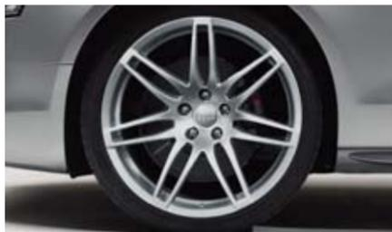
Llantas de aleación de aluminio Audi exclusive con diseño de 7 radios dobles, tamaño 9 J x 20 con neumáticos 265/30 R 20. Una oferta de quattro GmbH
