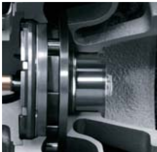
Aletas canalizadoras cerradas.
