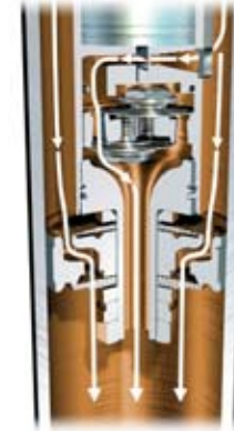
Fase de estiramiento – émbolo de trabajo y derivación, ajuste deportivamente duro
