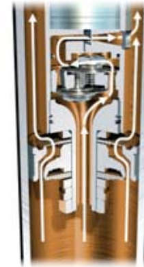
Fase de compresión – émbolo de trabajo y derivación, ajuste deportivamente duro
