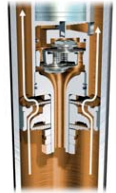
Fase de compresión – émbolo de trabajo solo, ajuste de dureza de competición
