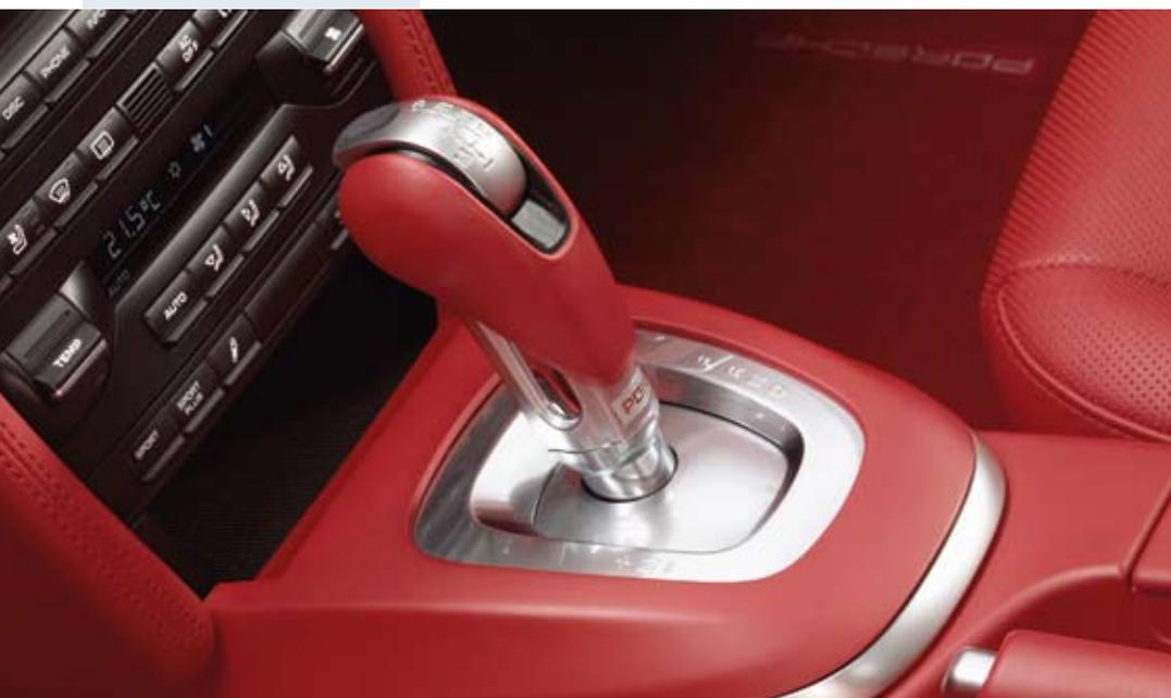
Palanca selectora del cambio Porsche Doppelkupplung (PDK)
