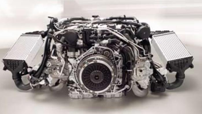
Motor con radiador del aire de sobrealimentación
