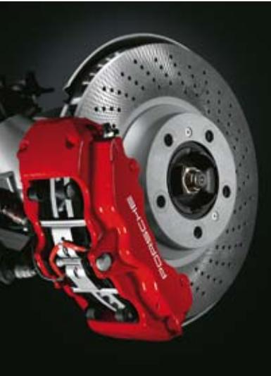
Sistema de frenos de serie del 911 Turbo (eje delantero)
