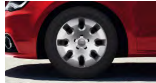
□ Llantas de acero con tapacubos integrales, tamaño 6 J x 15 con neumáticos 185/60 R 15 (exclusivo en 1.2 TFSI Attraction); tamaño 6,5 J x 15 con neumáticos 205/55 R 15 (exclusivo en Attraction, no disponible para 1.2 TFSI).
