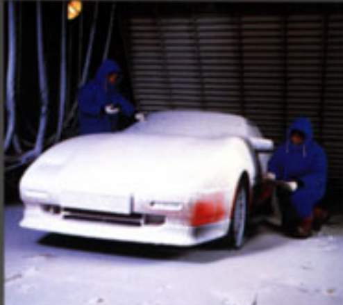
All-weather test (sub-zero)
