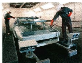
Die Karosserie eines jeden Wagens wird zusammen mit den Anbauteilen von erfahrenen Technikern sprühtrocknet, damit die Toleranzen perfekt stimmen.
