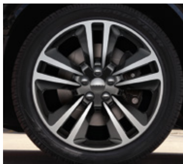
Ruedas de aluminio forjado y pulido de 20 pulgadas con bolsillos en negro (estándares en SRT® Core)
