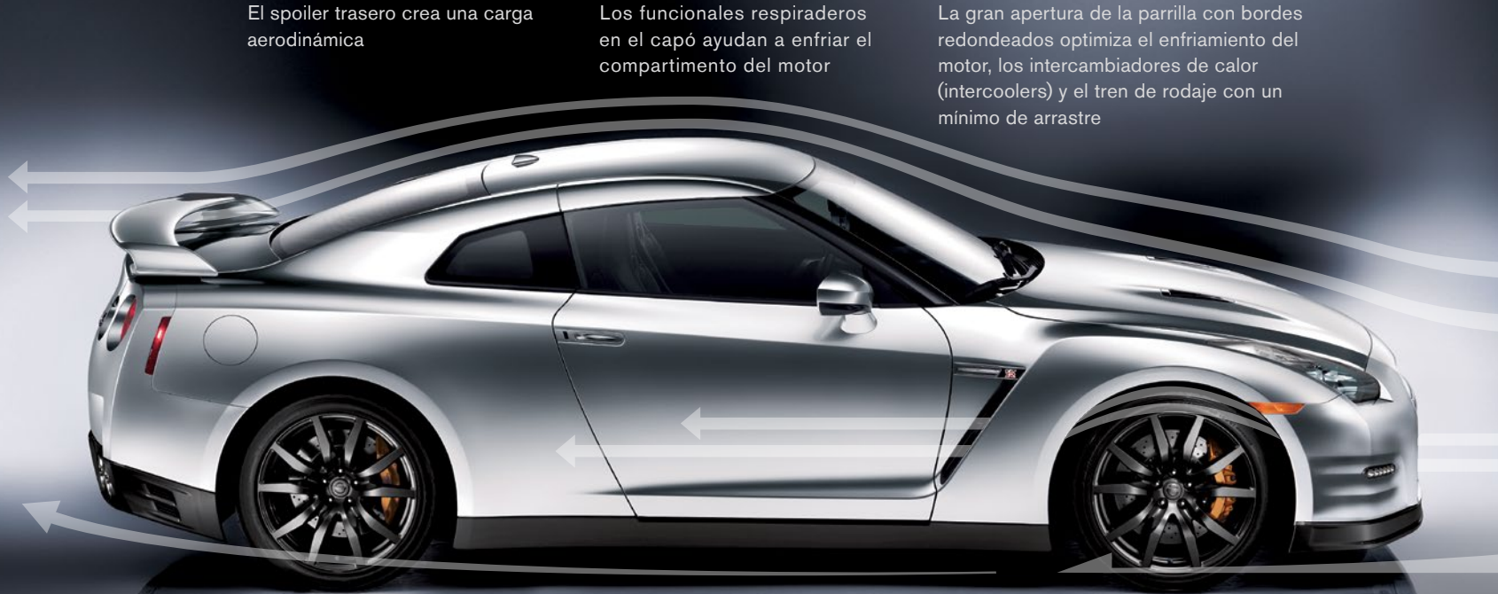
La rejilla en la parte lateral de la defensa trasera ayuda a dirigir el flujo de aire hacia la parte trasera del vehículo
