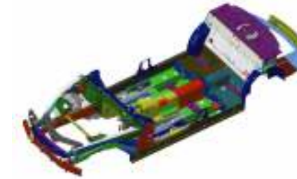
Scocca ad elementi finiti Bodywork FEM analysis
