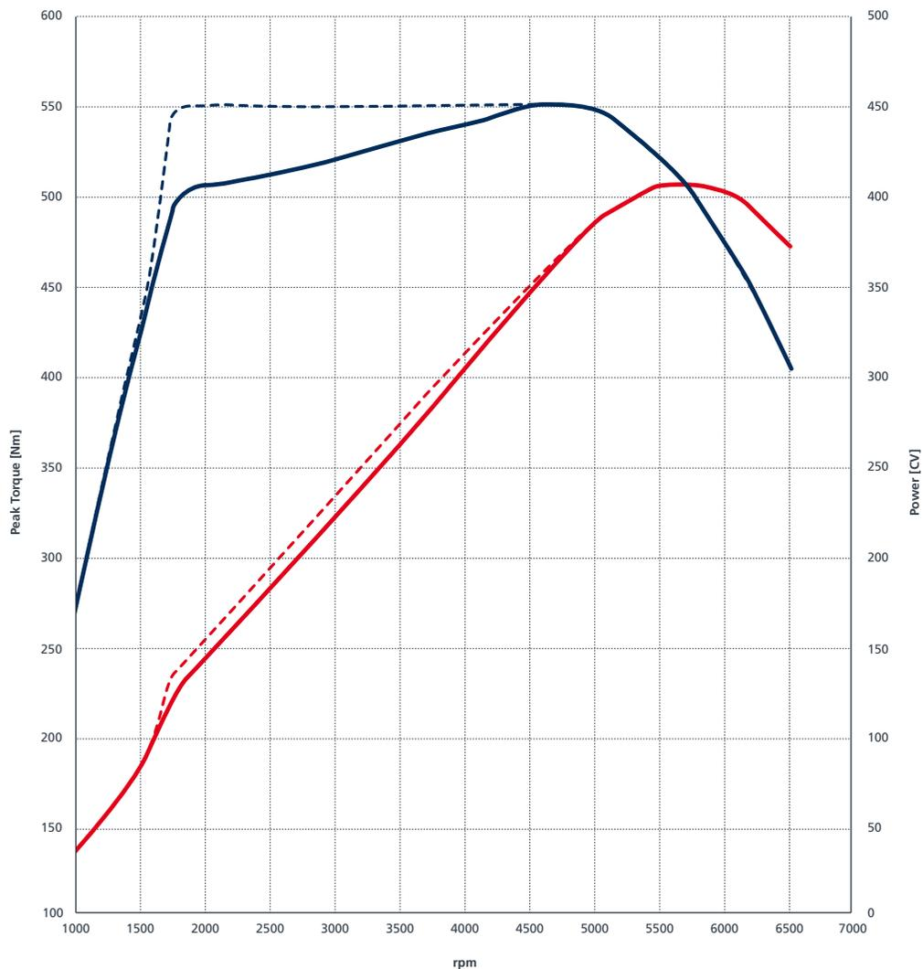
La utilización de dos turbocompresores de baja inercia montados en paralelo contribuye a eliminar el fenómeno del turbo lag, hecho que redundo en favor de la flexibilidad en cualquier situación de conducción. Otros novedosos recursos de ingeniería dirigidos a mejorar la eficiencia son el sistema de inyección directa a alta presión (200 bares) y la adopción en las dos culatas de un doble variador de fase continuo, que puede adelantar o retrasar la apertura de las válvulas de admisión y
